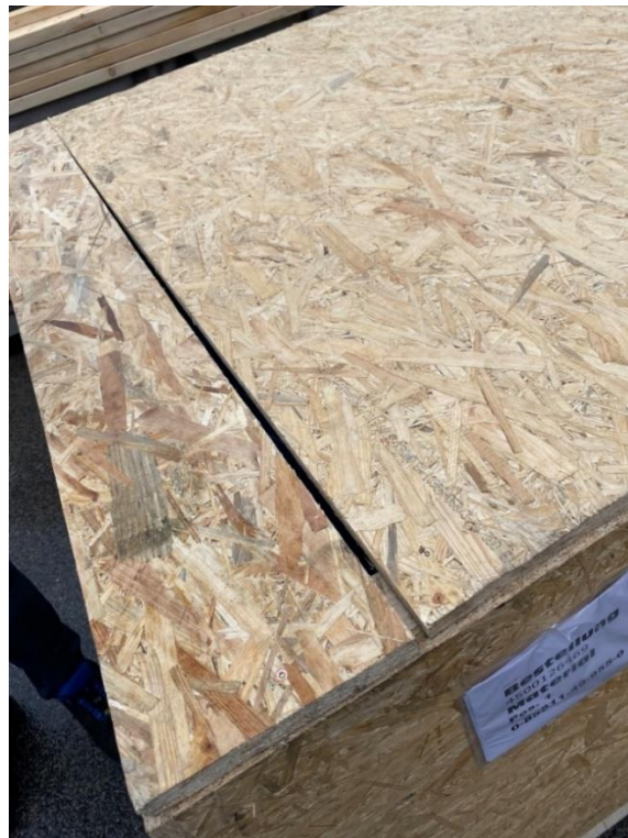
Abbildung 9: Fehlende Sperrschicht im Deckel
