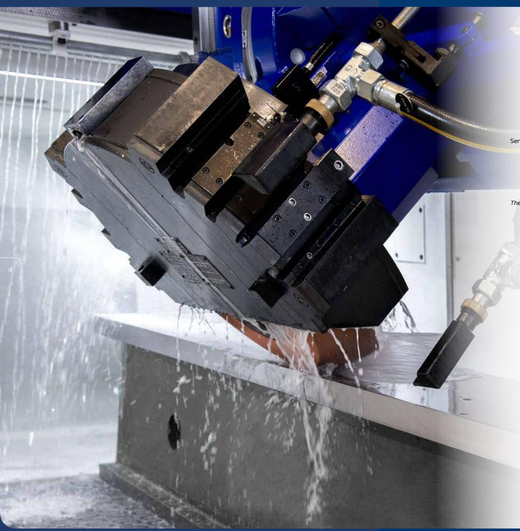
Schleifzentren stellen bei WALDRICH COBURG die Oberklasse dar und verfügen über die größte Leistungsfähigkeit und den höchsten Automatisierungsgrad. Sie sind geeignet für das Schleifen verschiedenster Flächen, Führungen und Betten mit höchster Genauigkeit.
