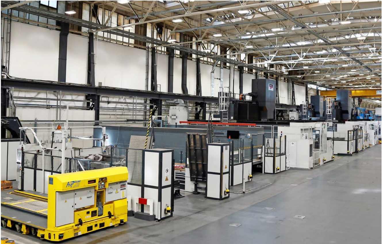
Gesamtansicht der Fertigungszelle mit drei Portalfräsmaschinen von Waldrich Coburg im Mercedes-Werk in Sindelfingen.
