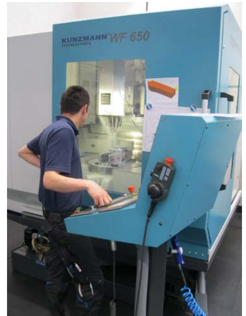
Nick beim fräsen der Kontur der Düse
