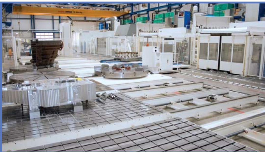
Flexible und rechnergesteuerte Palettensysteme made by Waldrich Coburg.
