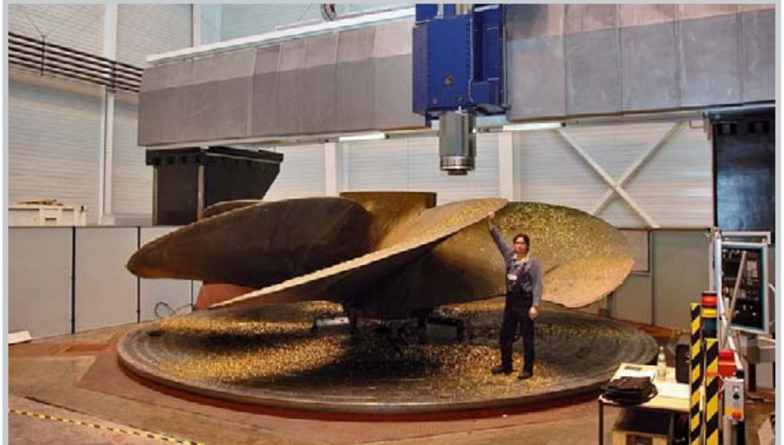
Die Portalfräsmaschine 10500 FR-S2 von Waldrich Coburg kann bei MMG nun Propeller bis zu einem Durchmesser von 10500 mm bearbeiten.
